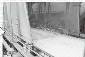
下から風をあて水分を飛ばし、冷却装置で冷やし込む
